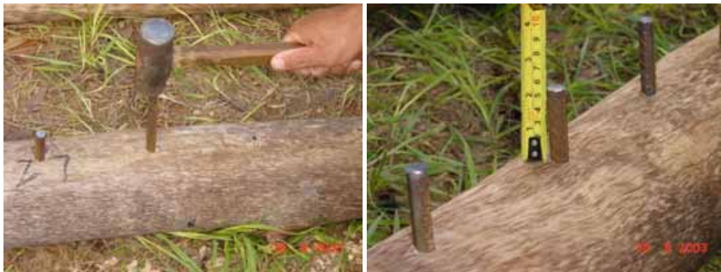
Figura 5 – Cravação e verificação da altura de ancoragem dos pinos
