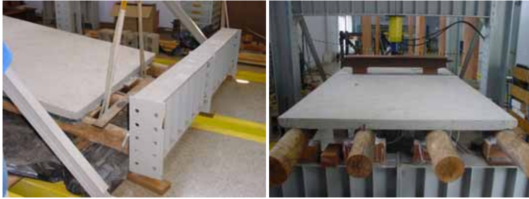
Figura 12 – Montagem do modelo para ensaio
