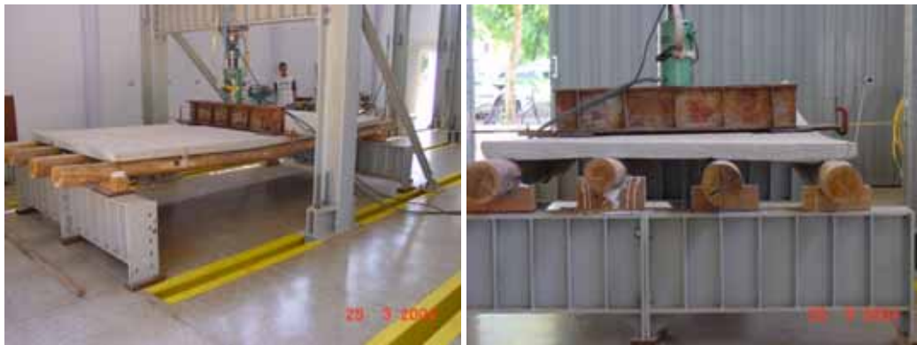
Figura 16 – Comportamento do modelo reduzido da ponte com carregamento distribuído
