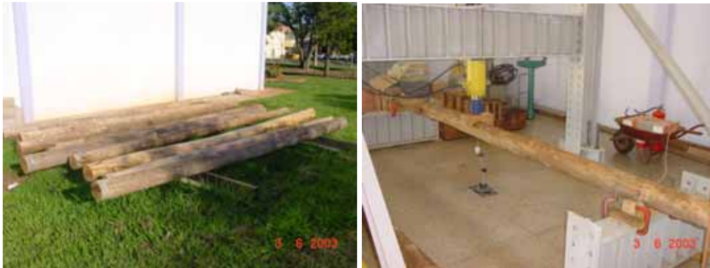
Figura 2 – Vigas de madeira bruta e ensaio de flexão estática
